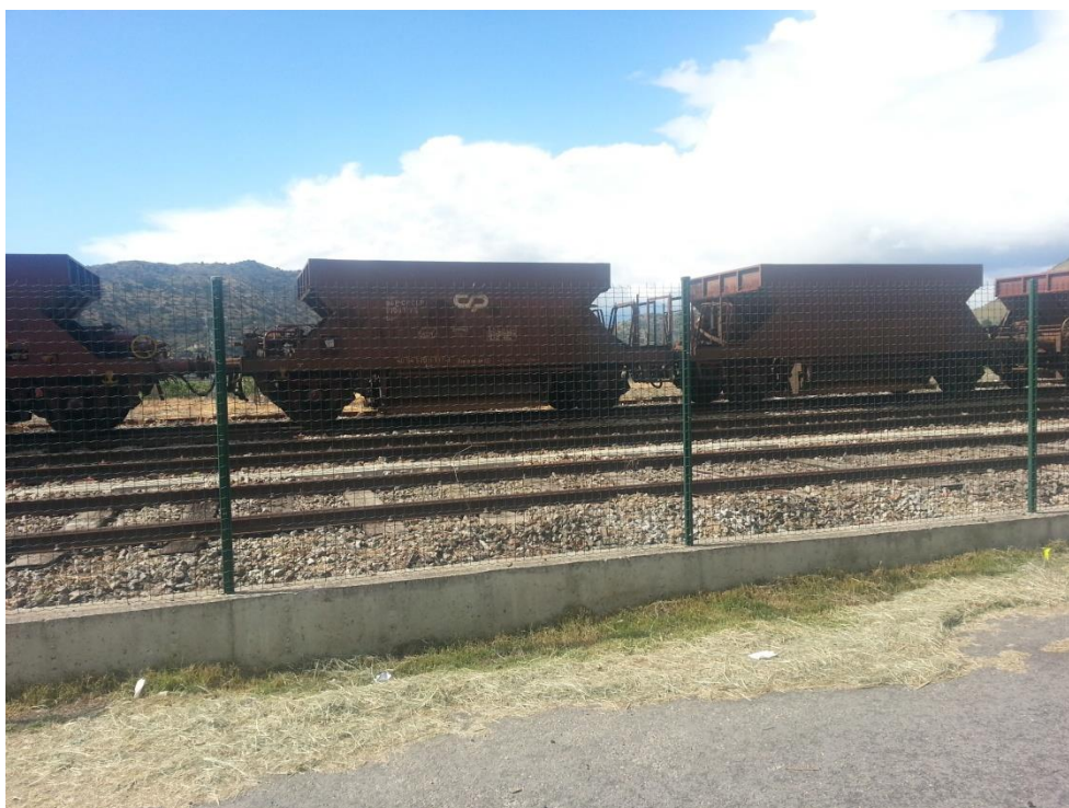
Figura 12 - Vagões para transporte de minério na Estação do Pocinho
