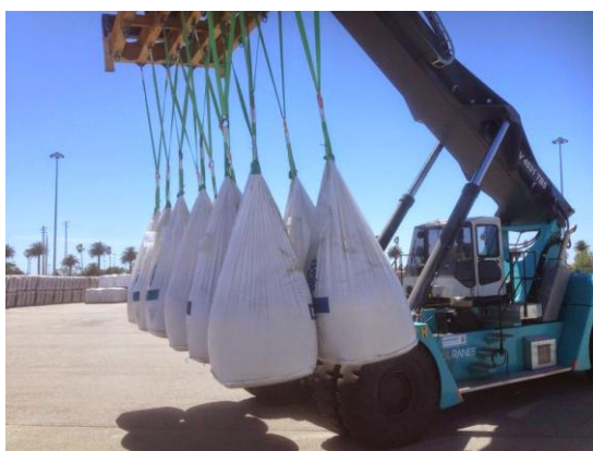
Figura 33 - Grua móvel multifunção, KoneCrane SMV 4531 TB5, com capacidade de elevação de 14 a 41 toneladas, em trasfega de “big bags” no porto de Aveiro
